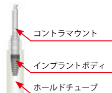
(図4) プラスチック容器内概要図
